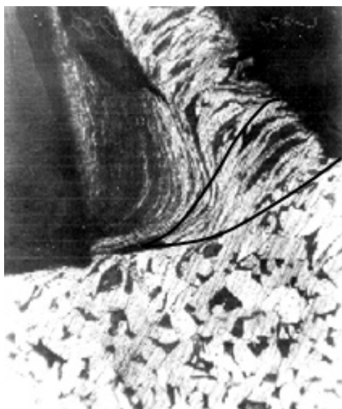
Рис. 4. Микрофотография шлифа корня стружки при резании стали 20 (x300)
