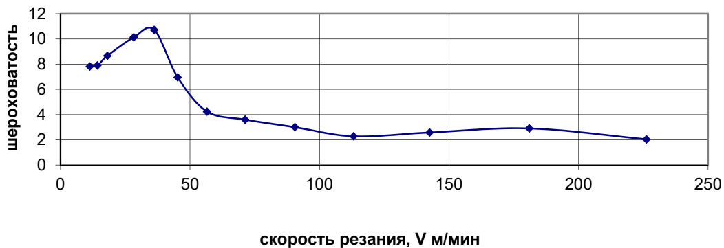
Рис. 8. Зависимость R_a шероховатости от скорости резания для стали 45. S = 0,11 мм/об.
