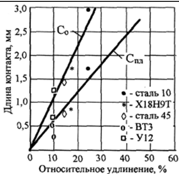
Рис. 5. Зависимость длины контакта стружки с передней поверхностью инструмента от относительного удлинения \delta обрабатываемых металлов
